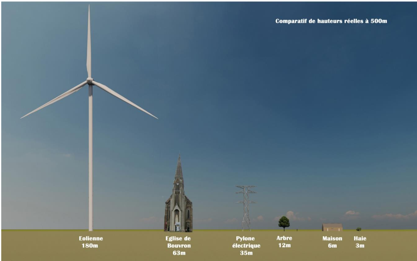
Hauteur réelle versus hauteur apparente. Distance à 500m. Dimensions : 40 x22,5cm sur papier représentant un champ visuel de 40° (horizontal) x 22,5° (vertical). Document à imprimer en forma A3 paysage et à lire à environ 35cm pour avoir une représentation fidèle. Source : 3D Paysage
